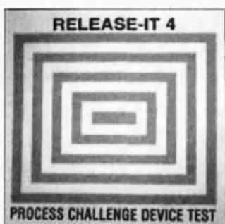
Рис. 65 LT 107. Неудовлетворительный результат. Повреждение вакуумной системы.
