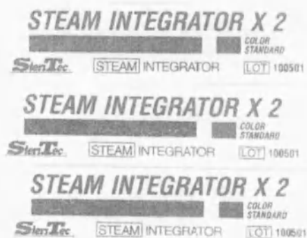
Рис. 102 CI 143. Неудовлетворительный результат. Индикатор содержит фиолетовый цвет, и это означает, что не все параметры паровой стерилизации соблюдены. Если пурпурный цвет остается на индикаторе, то тест не считается пройденным и все содержимое упаковки считается НЕ СТЕРИЛЬНЫМ.
