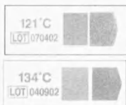
Рис.46 LT 102 (контрольный индикатор – слева, индикатор герметичности). Неудовлетворительный результат
