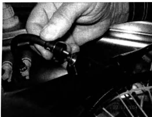
Рисунок 15 – Присоединение коннектора для промывки инструментального канала
