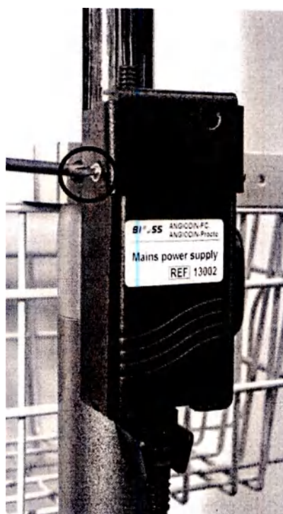
Рисунок 2.9. Фиксация скобы кронштейна блока питания
