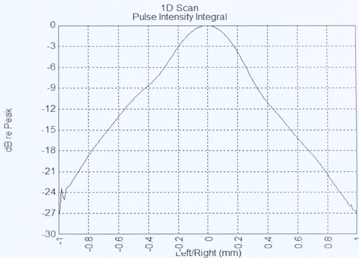
Рис. 40 PW-режим. Ширина УЗ пучка в максимуме I_{pi,a} на оси X
