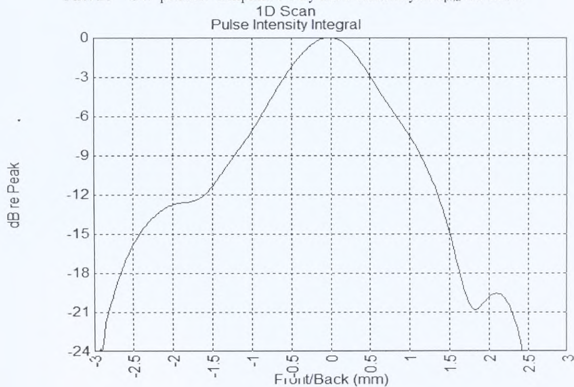
Рис. 26 CW-режим. Ширина УЗ пучка в максимуме I_{pi,a} на оси X
