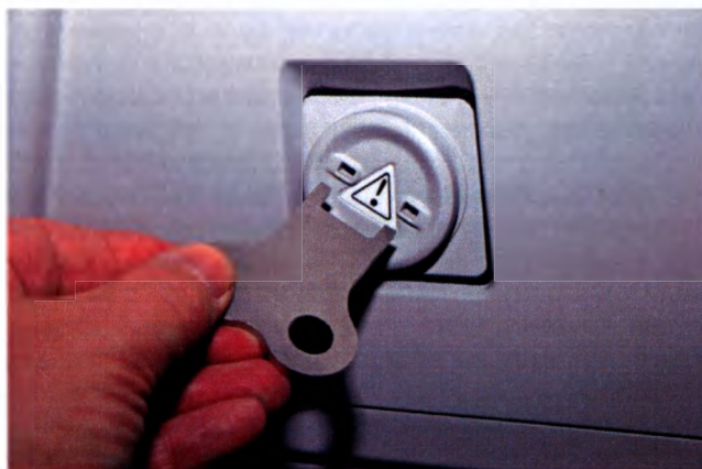
Рис. 5. Крышка водяного бака и ключ для открытия крышки для залива дистиллированной воды
