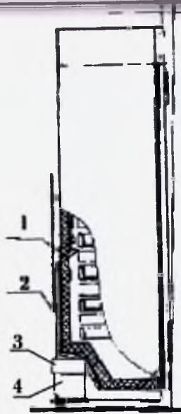
1-лоток; 2-водоотвод; 3-емкость талой воды; 4-компрессор
