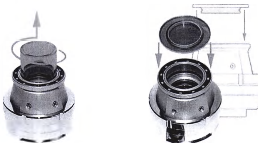
Изображение 19. Вставка стеклянной трубки и поляризующего фильтра в объектив для дерматоскопии.
