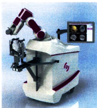
Система ROSA с системой фиксации опорной со штангой поддерживающей, и стереотаксической рамой Leksell
