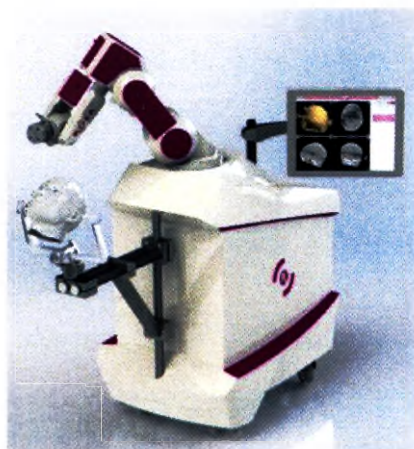
Система ROSA с системой фиксации опорной и фиксатором головы пациента типа Mayfield
