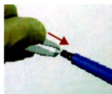
Рисунок 7-2 Замена фильтра на наконечнике
