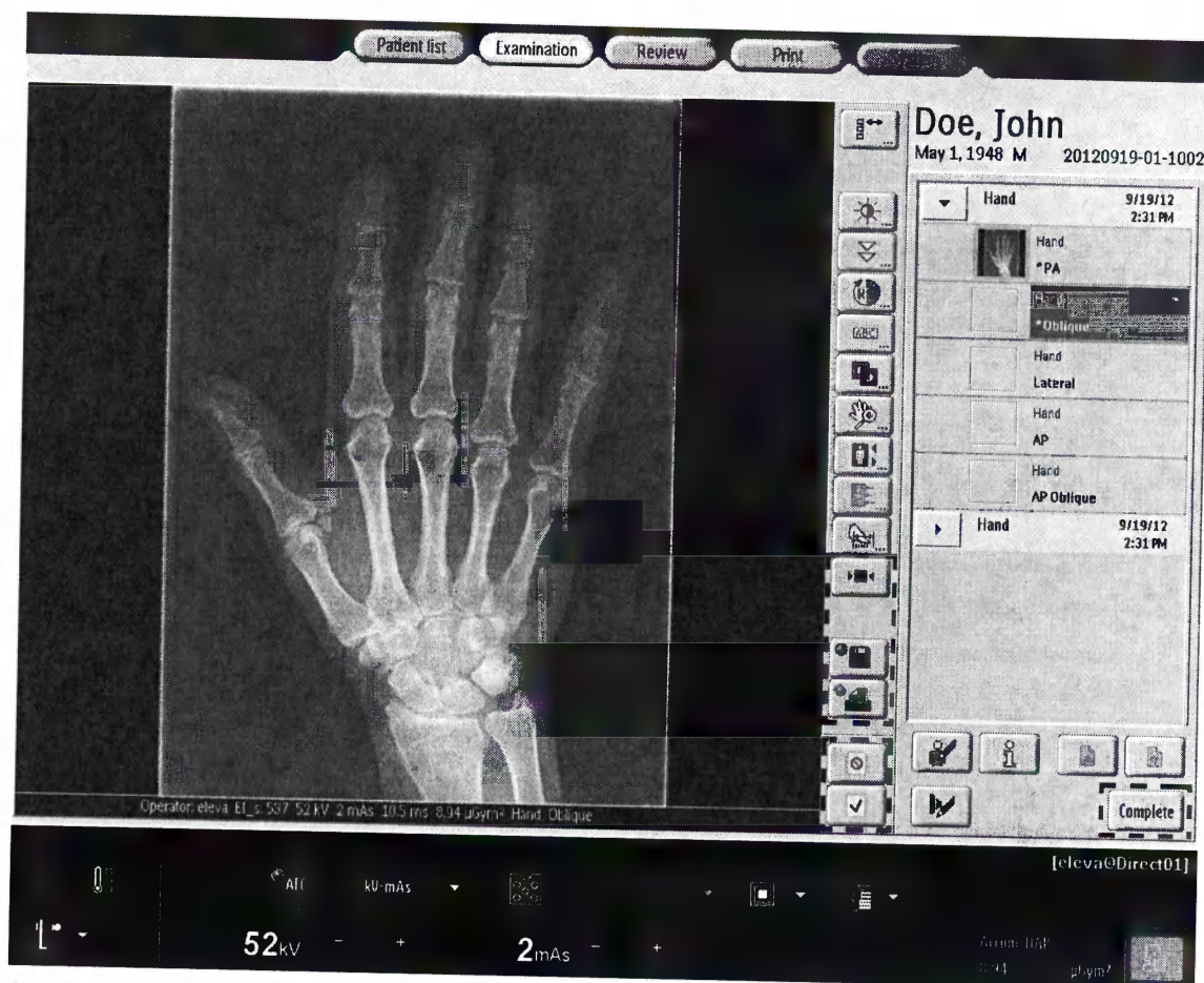
Рис. 6: Раздел «Examination» (Исследование) со встроенной панелью управления генератором Кнопки для повседневной рабочей процедуры:
