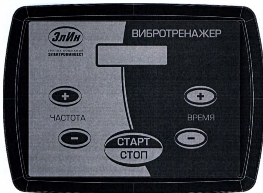
КЛАВИАТУРА НА ПУЛЬТ УПРАВЛЕНИЯ ВИБРОТРЕНАЖЕРОМ Эскиз №6 "Лицевая панель" М 1:1 Лист А4
