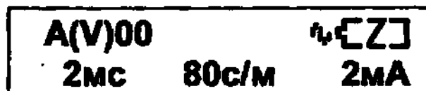
Рис.8.2. Требуется замена батареи. Изображение батареи мигает.
