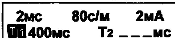
Рис.7.12. Режим программированной ЭКС с одним экстрасимулом. Задержка первого экстрасимула доступна для изменения.
