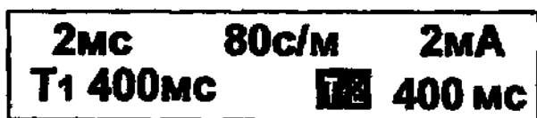
Рис.7.14. Режим программированной ЭКС с двумя экстрасимулами. Задержка второго экстрасимула доступна для изменения.
