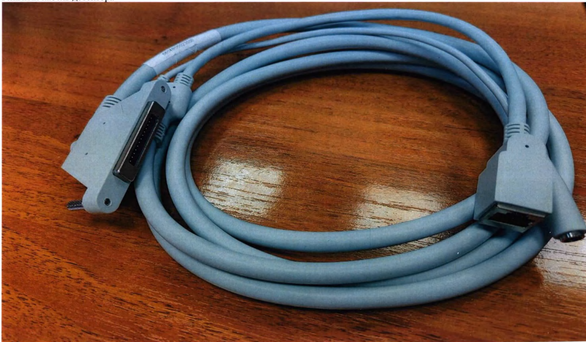
Главный кабель детектора
