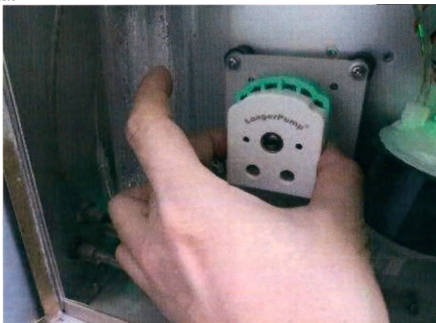
Рисунок 143 Снимите сальник перистальтического насоса
