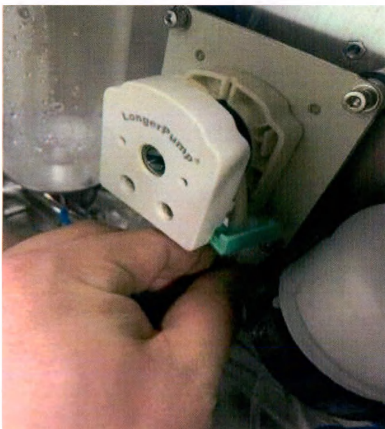
Рисунок 147 Установка новой трубки перистальтического насоса
