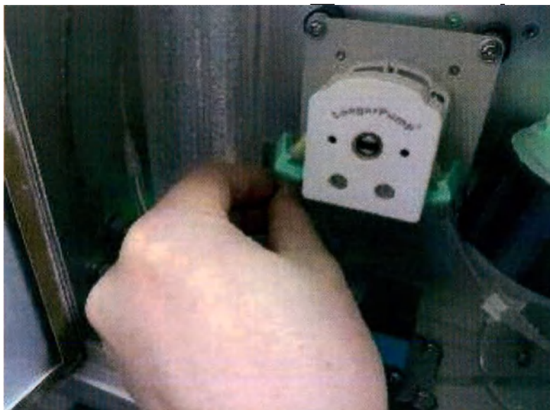
Рисунок 145 Снимите фиксирующие зажимы трубки перистальтического насоса
