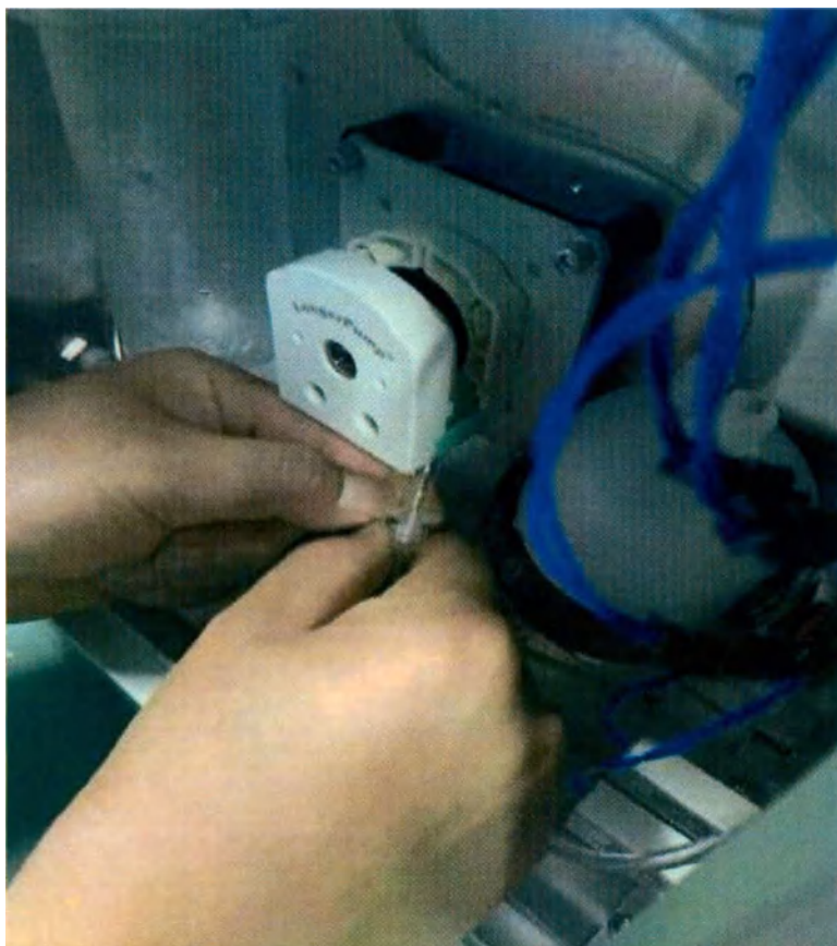
Рисунок 144 Открутите соединения типа «Луер Лок» с обеих сторон трубки
