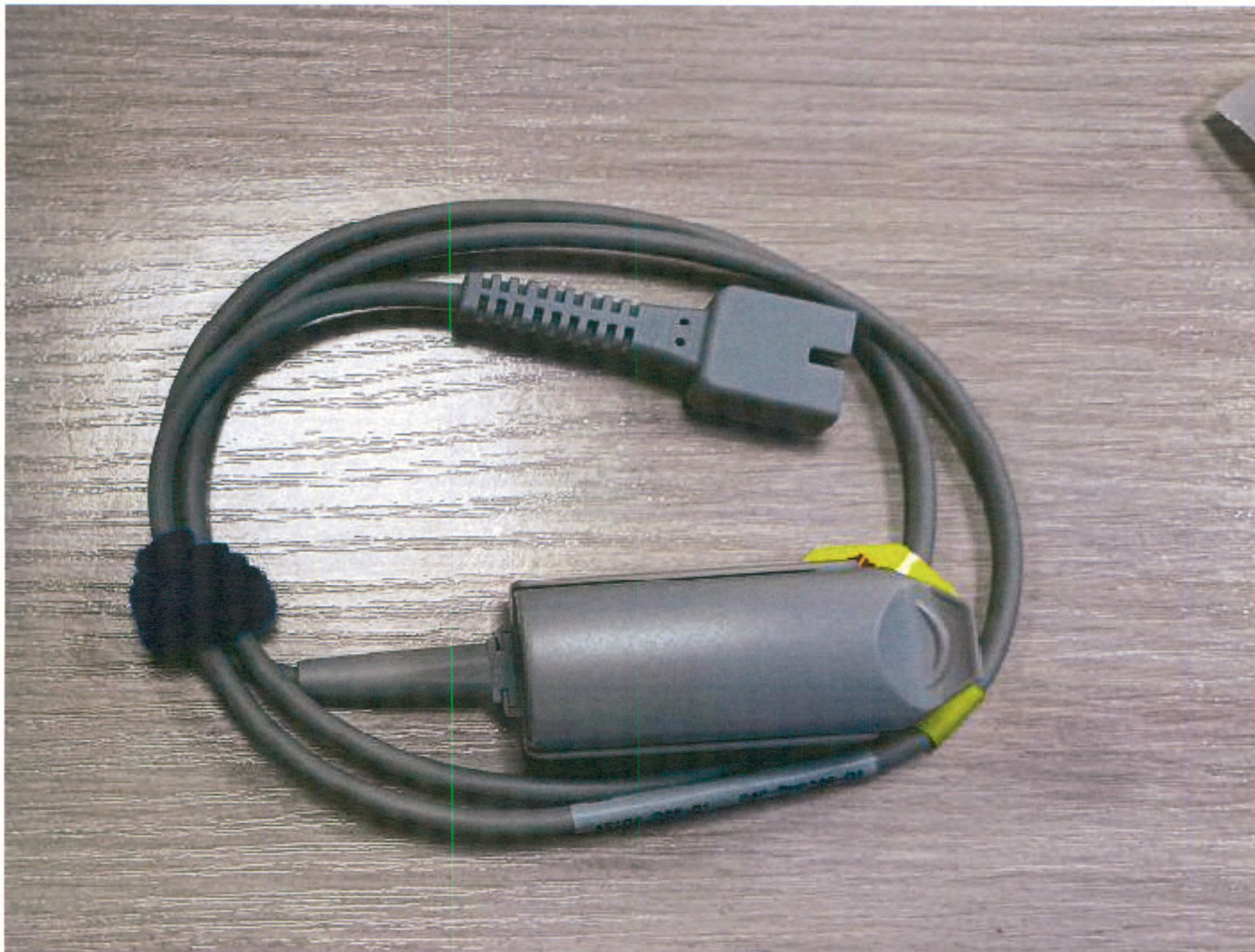
Многоцветный датчик SpO 2 с зажимом для пальцев для взрослых
