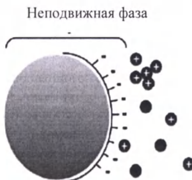
Рисунок 1. Схема принципа разделения HbA1c
