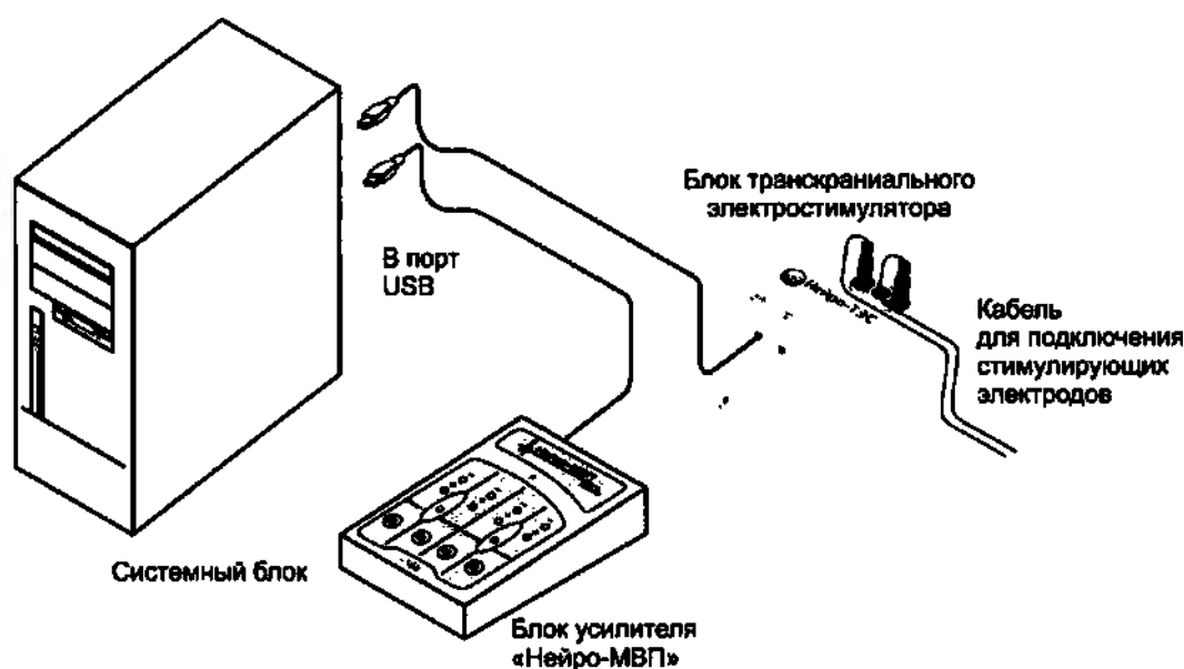
Рис. 15. Подключение блока транскраниального электростимулятора «Нейро-ТЭС» к комплексу «Нейро-МВП-4».
