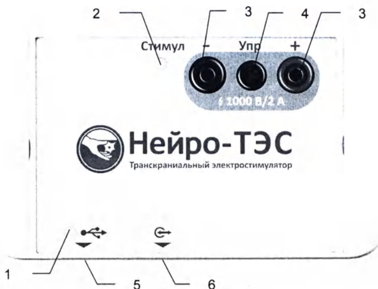
Рис. 4. Передняя панель блока транскраниального электростимулятора «Нейро-ТЭС».
