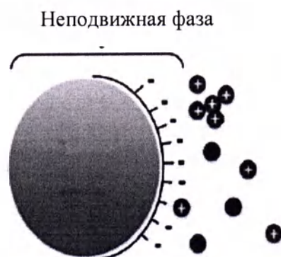
Рисунок 1. Схема принципа разделения HbA1c
