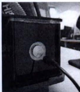
[1] Отсоедините Силовой кабель 24V
