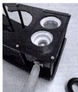
[4] Вытолкните увлажнитель воздуха из штатива
