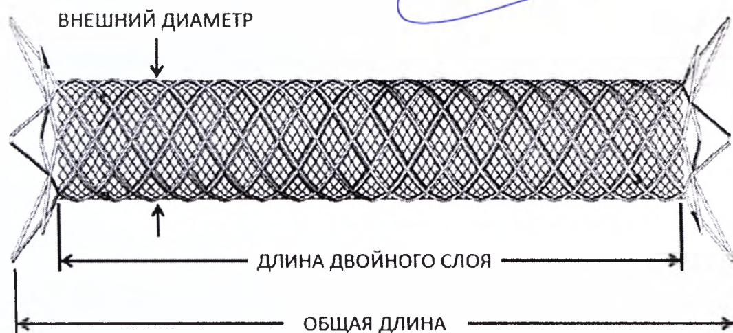
Рис.2 Стент каротидный CASPER в раскрытом состоянии
