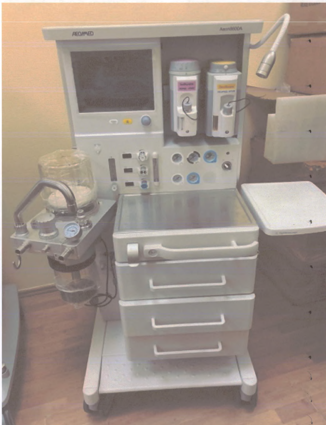
Общий вид Системы анестезиологической AEON 8600A и AEON 8600A LITE (Основной блок аппарата ингаляционной анестезии на тележке с тремя выдвижными ящиками, рабочей поверхностью (столиком) и боковой откидной полкой)
