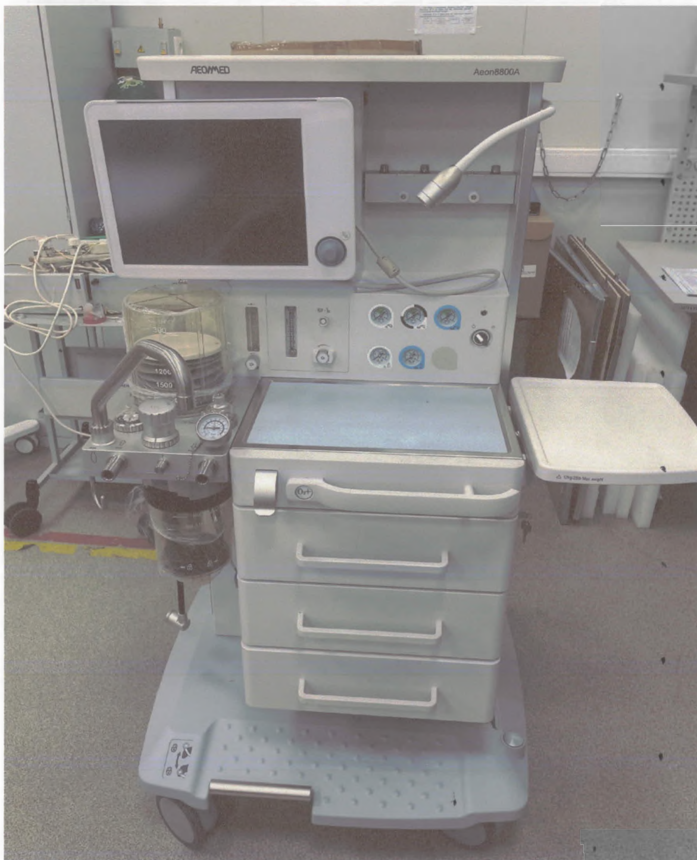
Общий вид Системы анестезиологической AEON 8800A (Основной блок аппарата ингаляционной анестезии на тележке с тремя выдвижными ящиками, рабочей поверхностью (столиком) и боковой откидной полкой)
