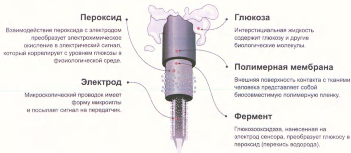
Рисунок - структура электрода сенсора
