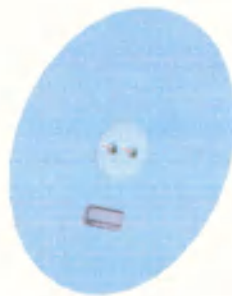
Рисунок - внешний вид обратной стороны сенсора, электроды и удерживающий пластырь, нанесенный на основание сенсора
