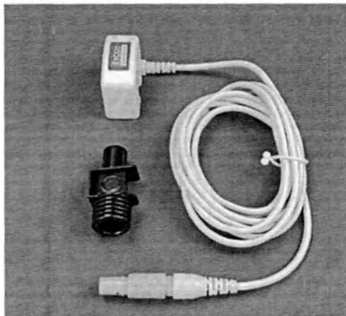
Рисунок 8.3 – Датчик капнографический и адаптер датчика капнографического
