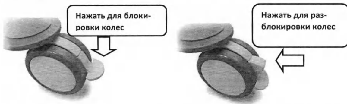
Рисунок 3.1 - Управление стопорным механизмом колес тележки аппарата
