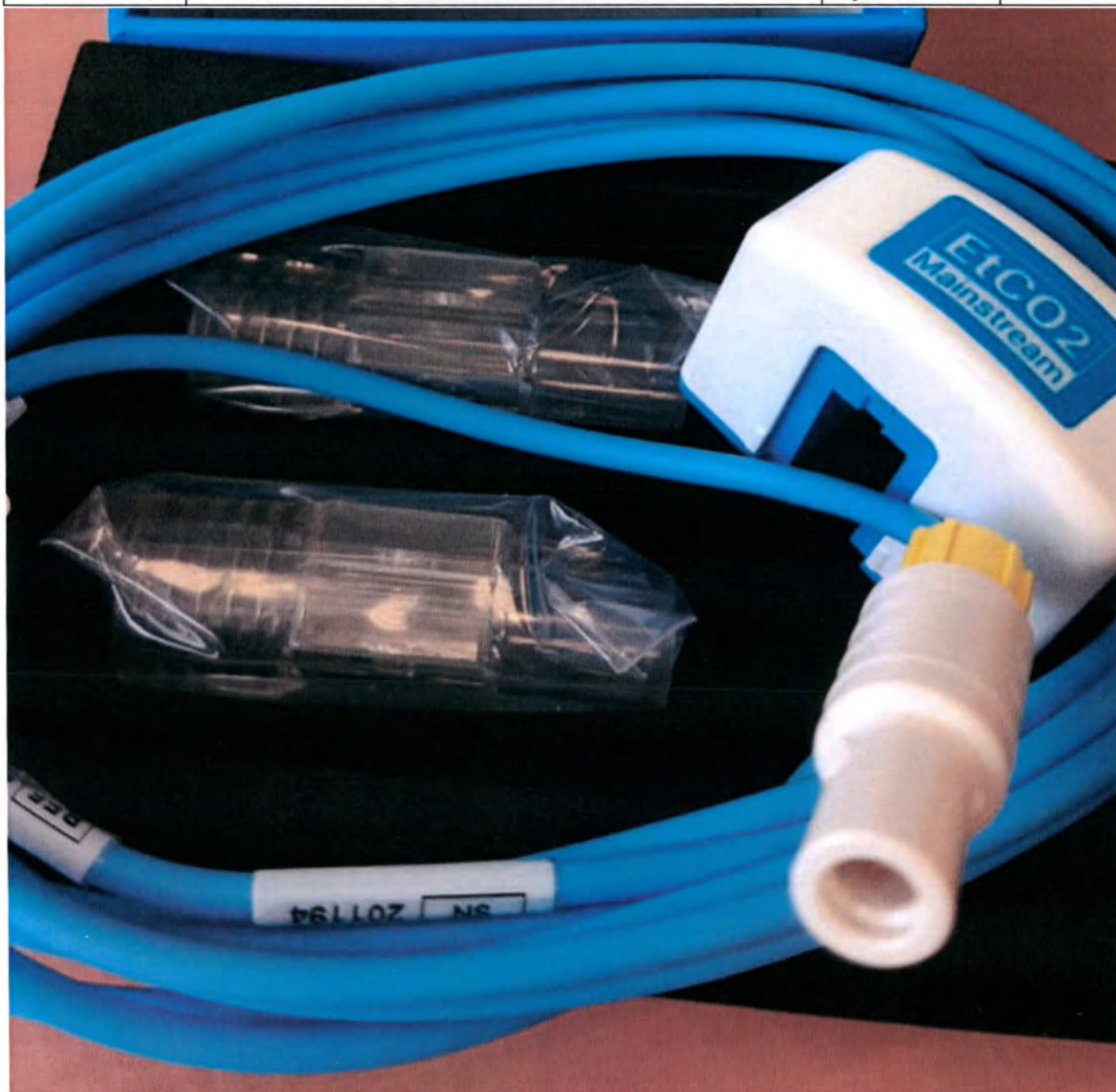
Фотографическое изображение 111 – Датчик катнографический Capnored в прямом потоке CMZ10, производства Qinhuangdao Каринуомаите Medical Equip ment S&T Co., Ltd., Кунтай, (для вариантов исполнения аппарата: 2 – 4)
