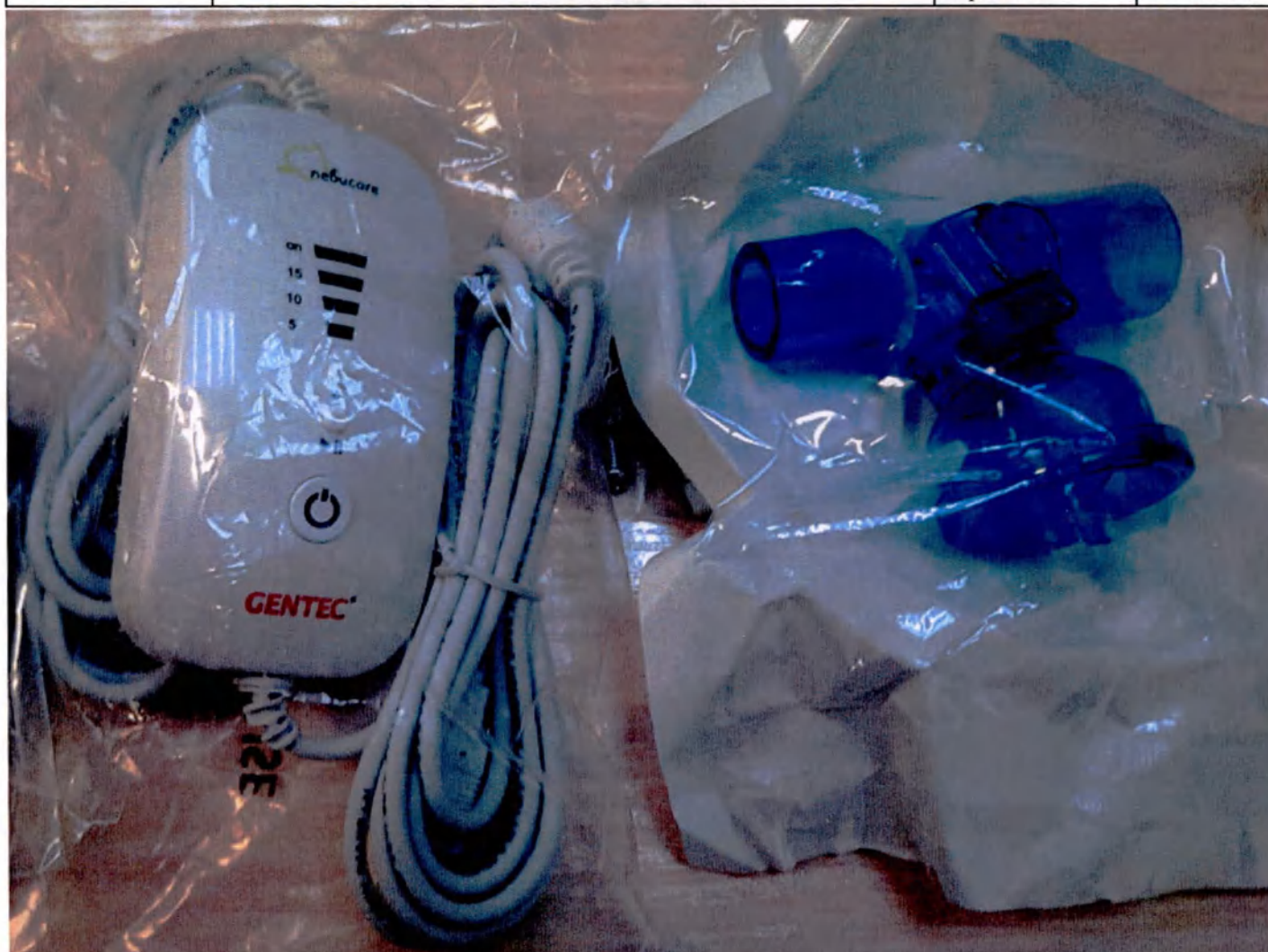
Фотографическое изображение 83 – Небулайзер микропомповый GUN-300vt в составе: Блок управления, к/н GUN-300vt-DC; Распылитель с Т-коннектором, к/н B16300640, производства Gentec (Shanghai) Corporation, Китай, общий вид (для всех вариантов исполнения аппарата)
