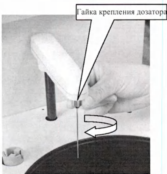
Удаление дозатора
