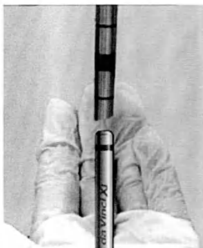
Без повреждений – калибровочный штифт проходит
