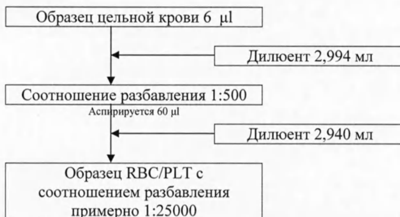
Фигура 1-1: Процесс разбавления для анализа на эритроциты / тромбоциты
