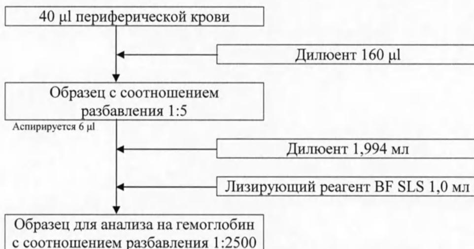
Фигура 1-6: Процесс разбавления для анализа на гемоглобин
