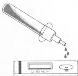
Рис. 1. Схема внесения образца в тест-кассету
