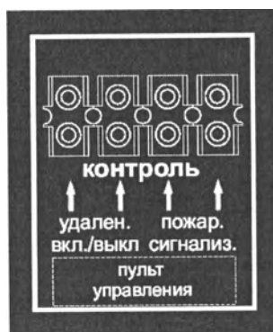
Рисунок 2.11 — Клеммная колодка удаленного управления
