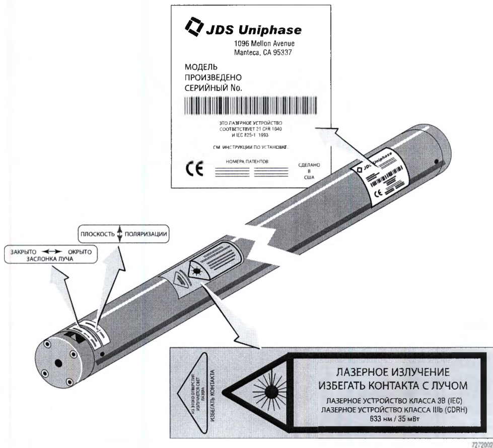
Рис. 6.8 Размещение дополнительного красного гелий-неонового лазера в приборе, вид сзади
