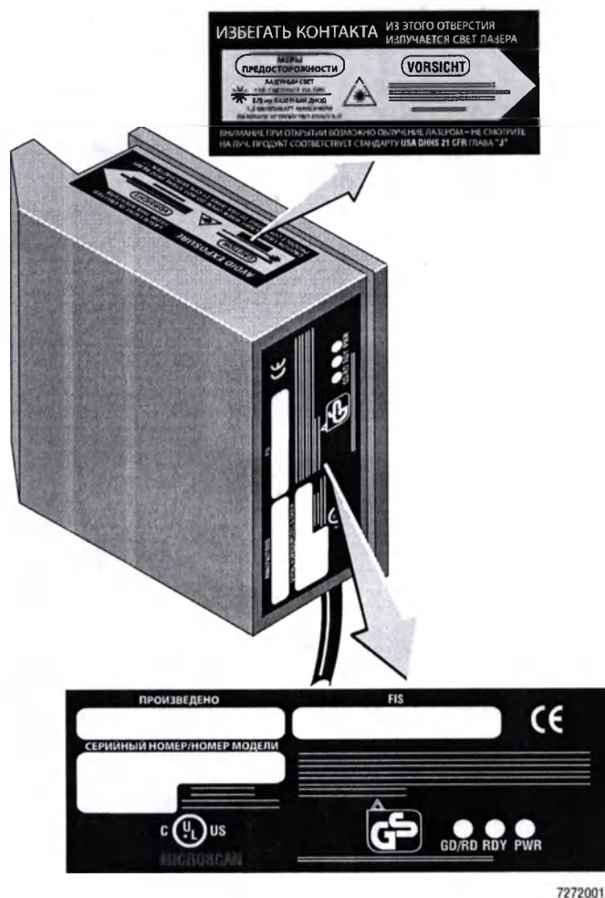
Рис. 6.11 Знаки для лазера на инструменте для MCL для чтения штрих-кода
