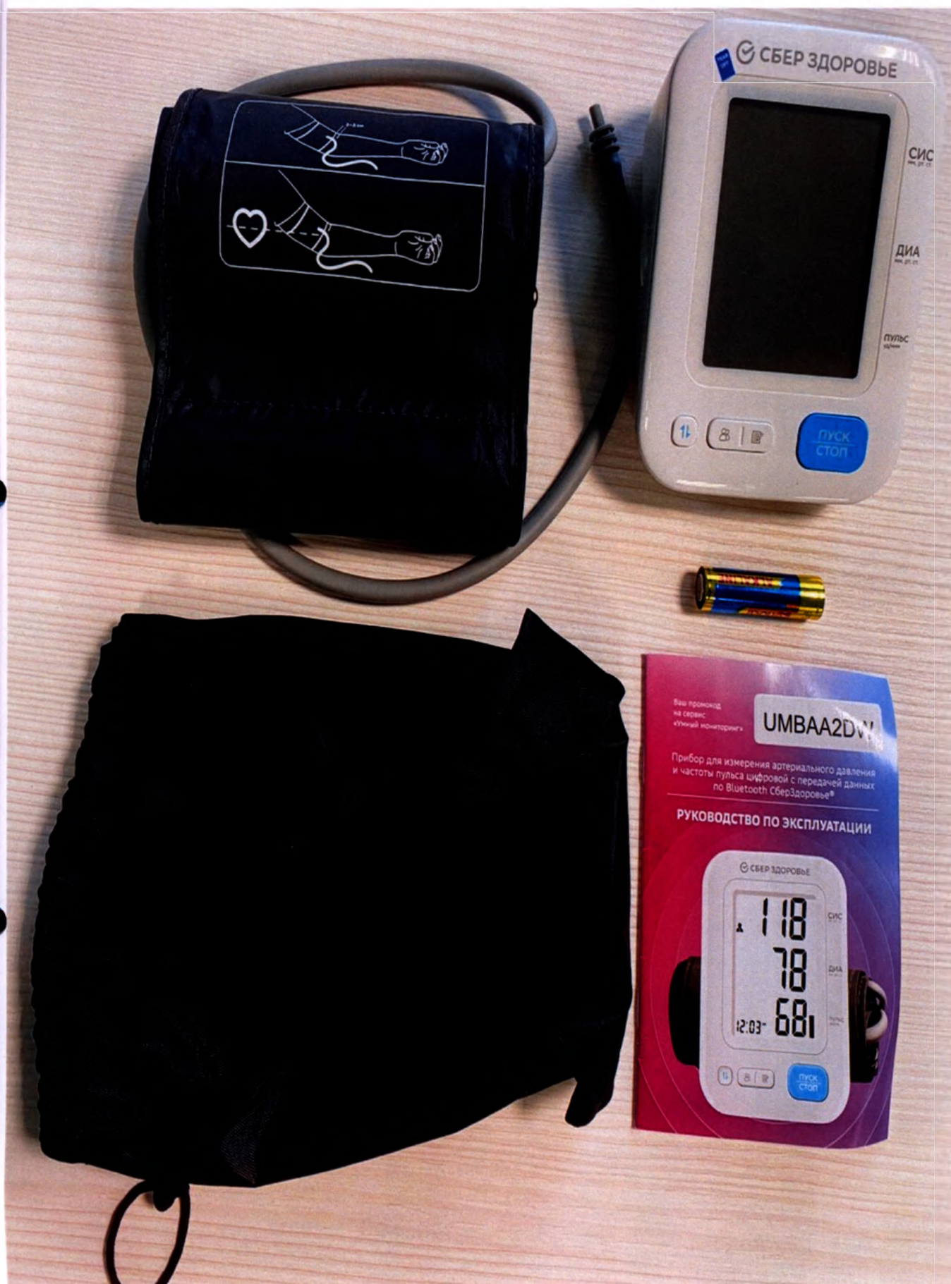
Фото 1 - Прибор для измерения артериального давления и частоты пульса цифровой с передачей данных по Bluetooth с принадлежностями по ТУ 26.60.12-001-39468618-2023 (Общий вид)
