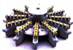
Рис. 10-1 Ротор на 12 карт (номер по каталогу 009411)
