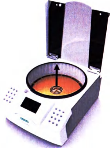
Рис. 7-1 Демонтаж основной системы нагрева
