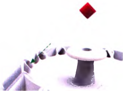
Рис. 32. Загрузка пробирок в ротор на 12 пробирок
