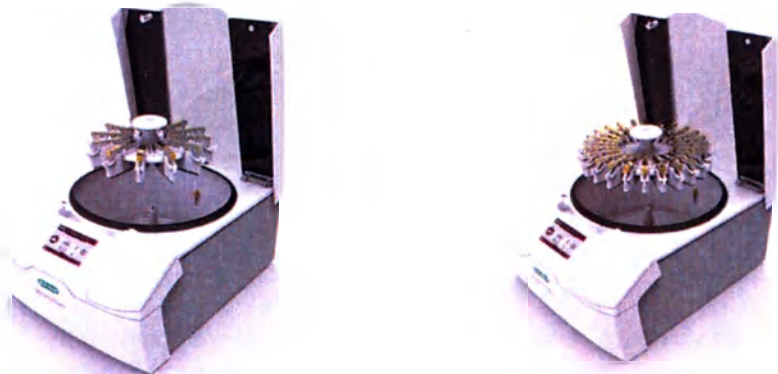
Рис. 45. Установка ротора на 12 карт / ротора на 24 карты
