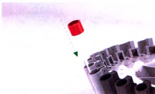
Рис. 31. Загрузка пробирок в ротор на 28 пробирок
