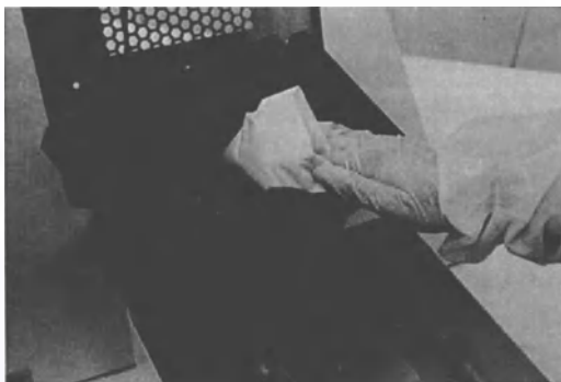
Рисунок 8.8 Очистка корпуса фильтра
