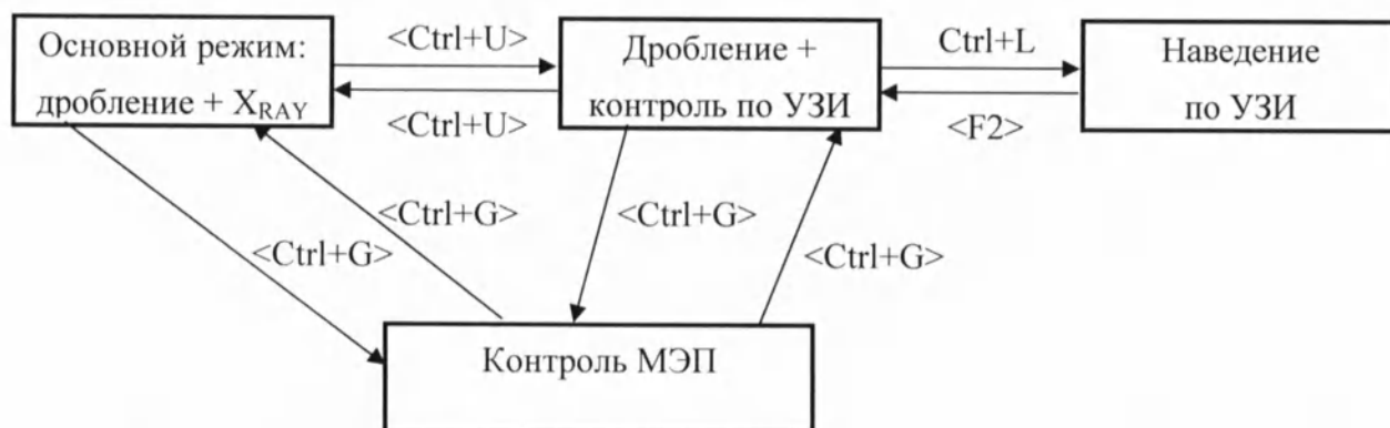
Рисунок В.1 – Схема взаимосвязей режимов работы программного комплекса
