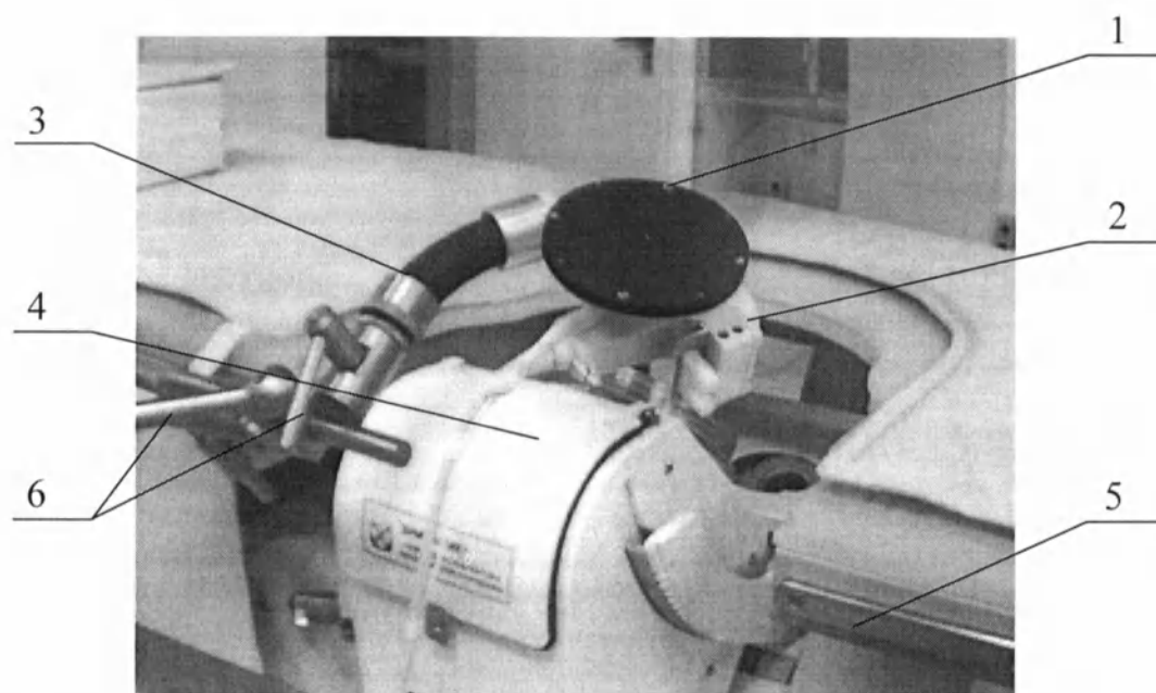
1 – насадка на УЗИ-датчика с маркерными светодиодами; 2 – УЗИ-датчик; 3 – держатель УЗИ-датчика; 4 – генератор ударных волн ГУВ; 5 – станина лежака; 6 – прижимные винты
