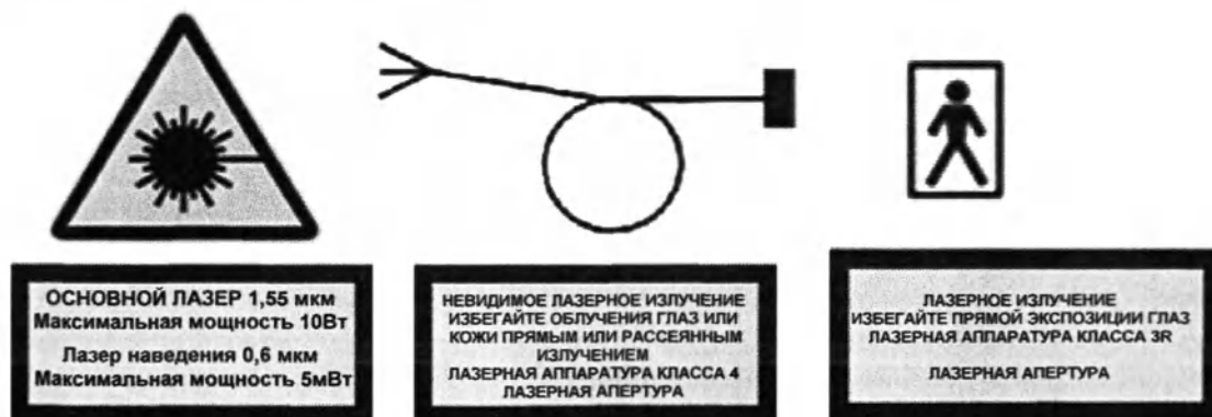
Рисунок 2. Маркировка места вывода излучения через Волоконный инструмент
