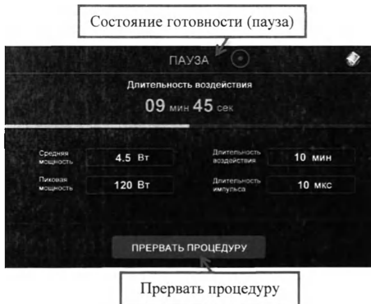
Рисунок 77. Состояние готов (пауза) при отжатой педали до окончания процедуры в режиме «ТЕРАПИЯ».
