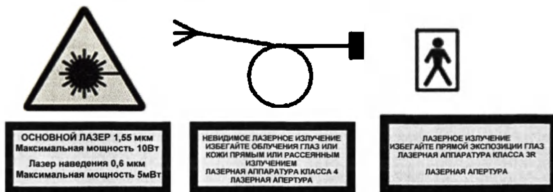
Рисунок 2. Маркировка места вывода излучения через Волоконный инструмент
