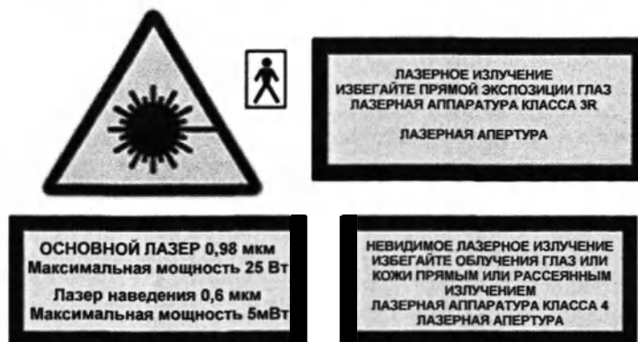
Рисунок 3. Маркировка места вывода излучения через Рукоятку волоконно-оптическую
