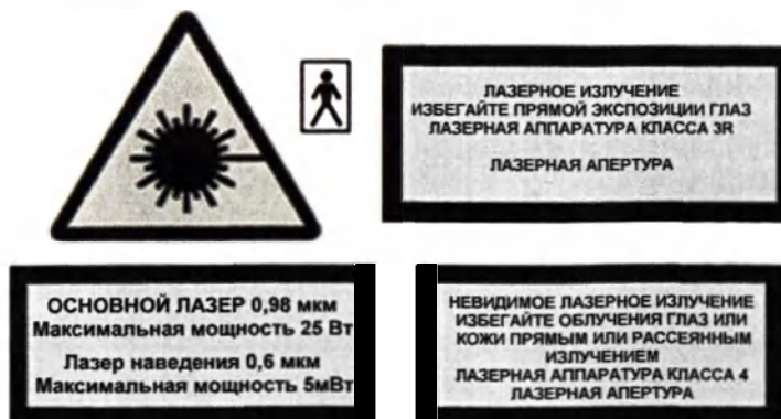
Рисунок 3. Маркировка места вывода излучения через Рукоятку волоконно-оптическую
