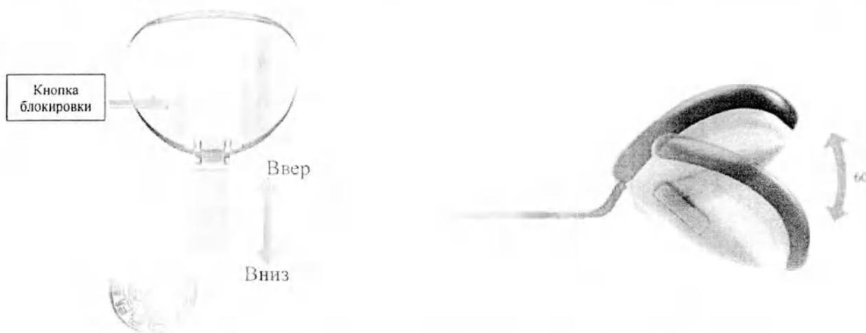
Рисунок 25 – схема регулировки положения подголовника
