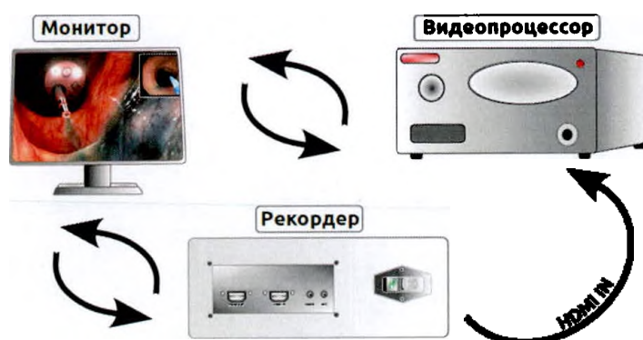
Рисунок 6 – Схема подключения Видеорекордера к видеопроцессору и/или монитору
