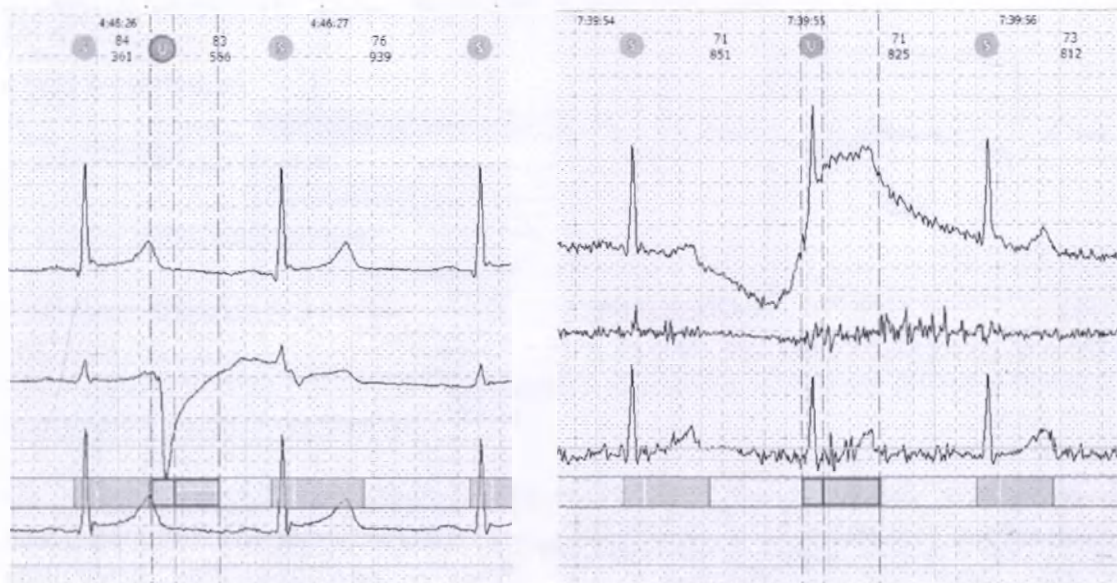
Рис. 14. Окно «Лента». Слева маркер комплекса «U» поставлен на случайном всплеске, который программа приняла за кардиокомплекс; такой маркер следует удалить. Справа маркер «U» поставлен на зашумленном комплексе; такой маркер удалять не нужно, поскольку это повлечет неверный расчет частоты сердечных сокращений (ЧСС)
