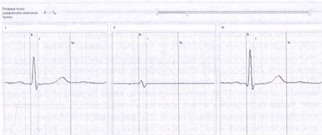
Рис. 9.12. Фрагмент окна «Редактирование группы» в режиме редактирования маркеров опорных точек представительного кардиокомплекса. В верхней части расположены ползунки для точной установки маркеров опорных точек. Маркеры («В», «J», «Те») изображены на фоне карт и представительного комплекса (на карте показан сплошной линией темно-синего цвета)
