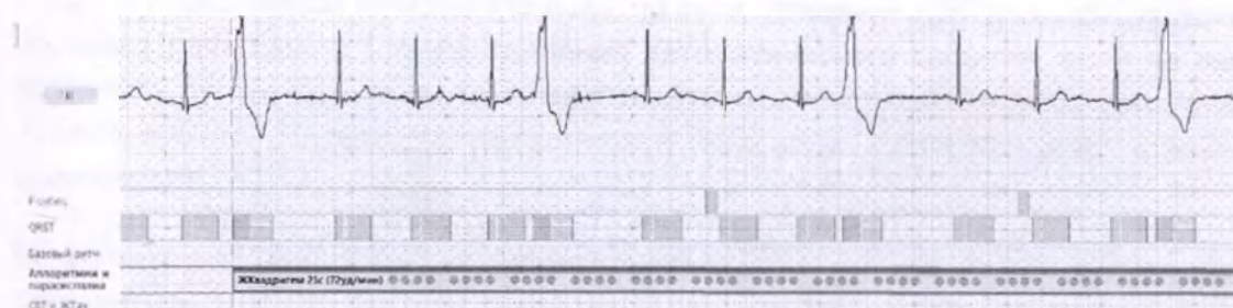
Рис. 8.26. Фрагмент окна «Лента» с треками событий. Границы выделенного события «Квадригеминия» на треке «Аллоритмии и парасистолия» совпадают с началами кардиокомплексов на треке «QRST»
