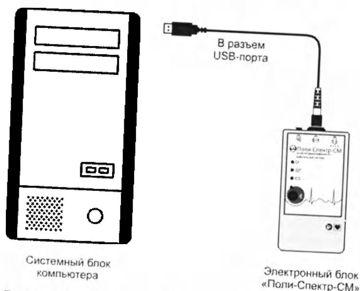
Рис. 10. Схема подключения регистратора к компьютеру
