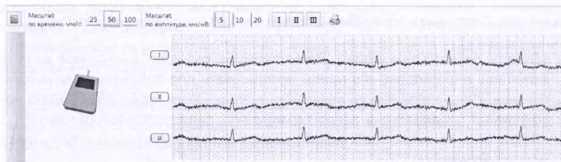
Рис. 3.5. Окно «Работа с регистраторами». Регистратор «Поли-Спектр-СМ». Подключение по Bluetooth. Мониторирование ЭКГ в режиме реального времени
