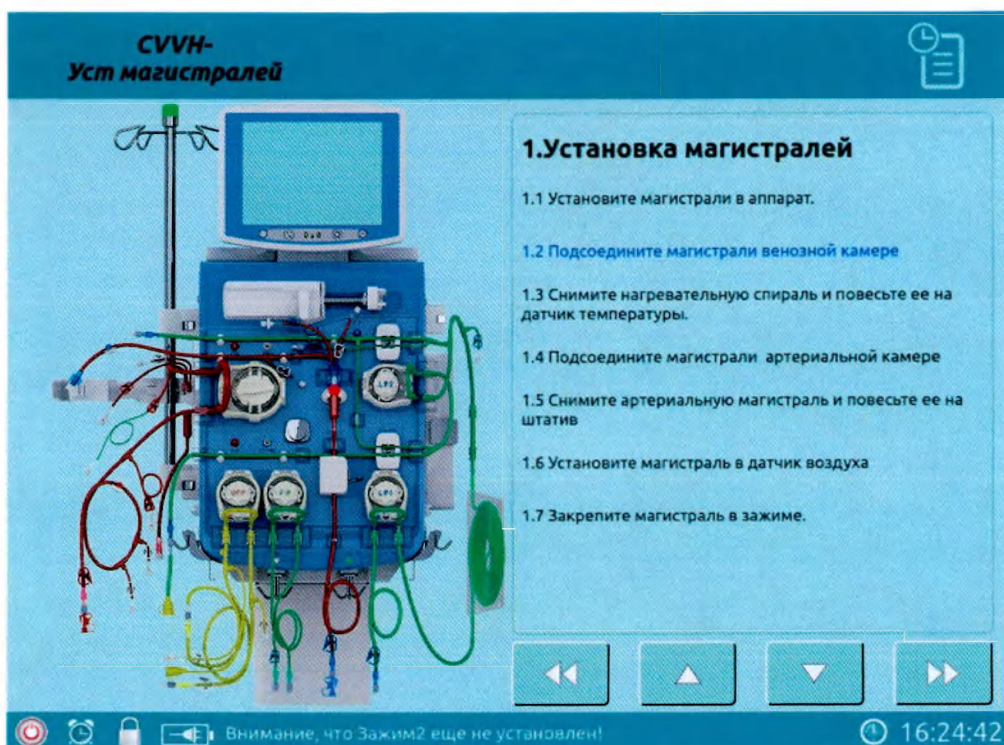
Рис. 6-21. Экран установки комплекта магистралей
