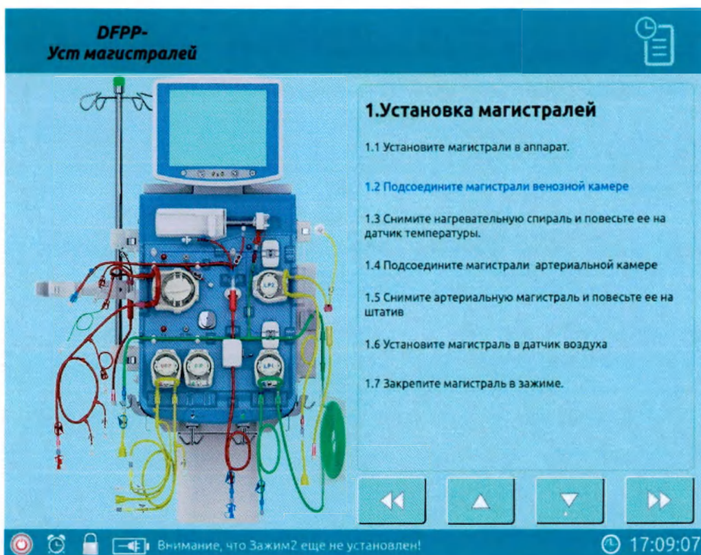
Рис. 6-45(а). Установка магистралей для ПФДФ
