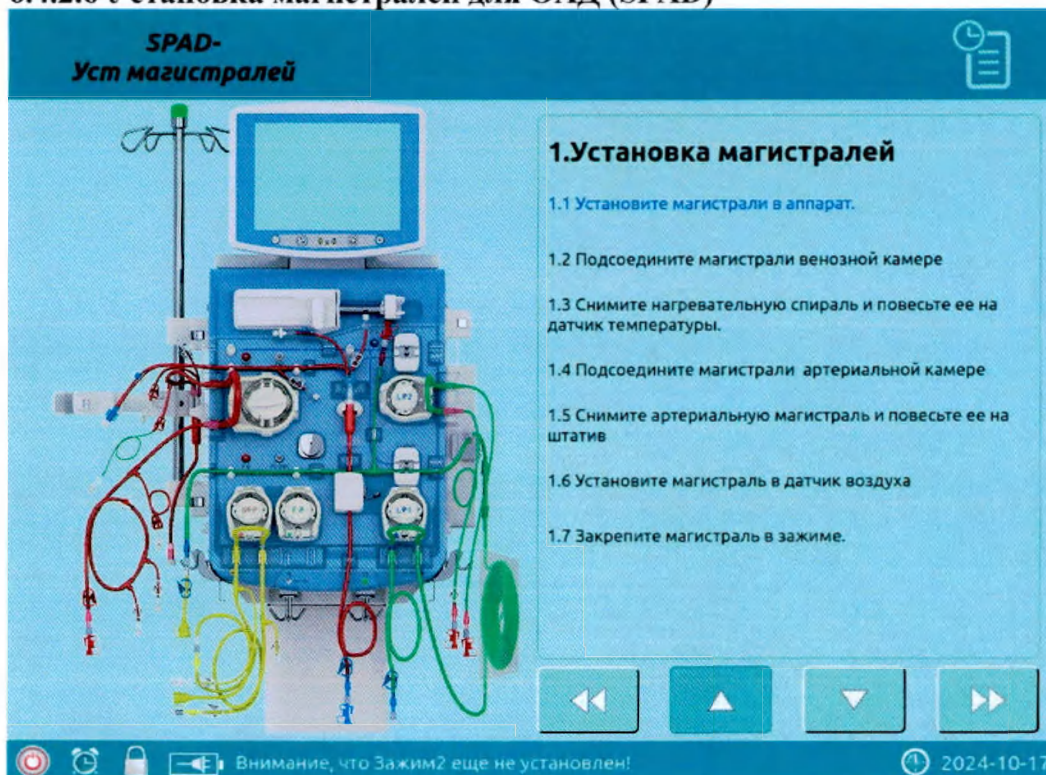
Рис. 6-55. Установка магистралей для СПФА (CPFA)
