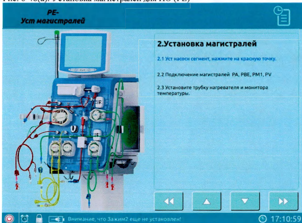
Рис. 6-48(б). Установка магистралей для ПО (РЕ)
