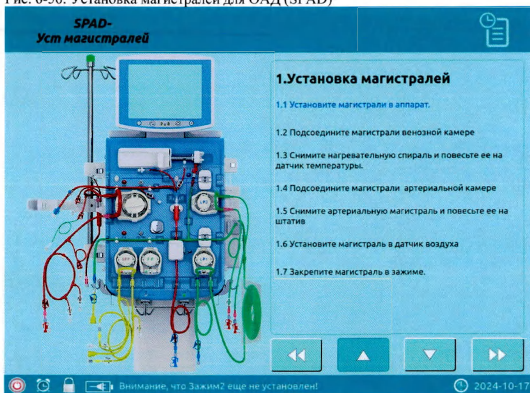
Рис. 6-57. Установка магистралей для ОАД (SPAD)
