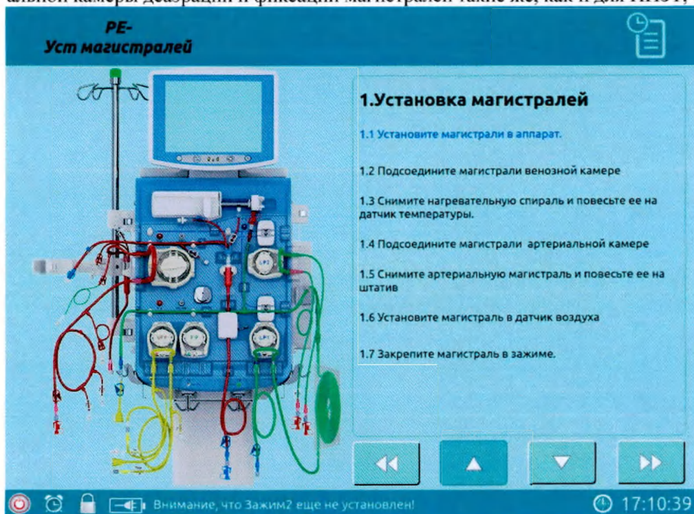
Рис. 6-48(а). Установка магистралей для ПО (РЕ)
