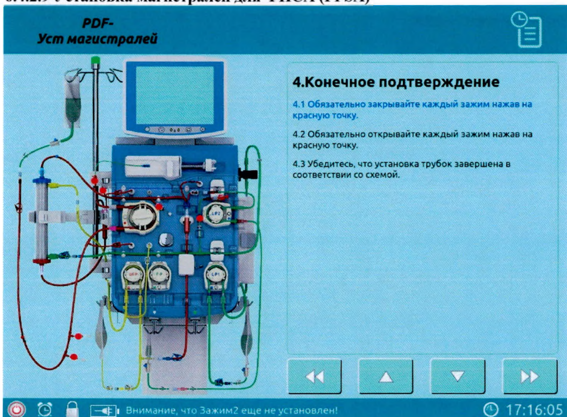
Рис. 6-63. Установка магистралей для ФПСА (FPSA)
