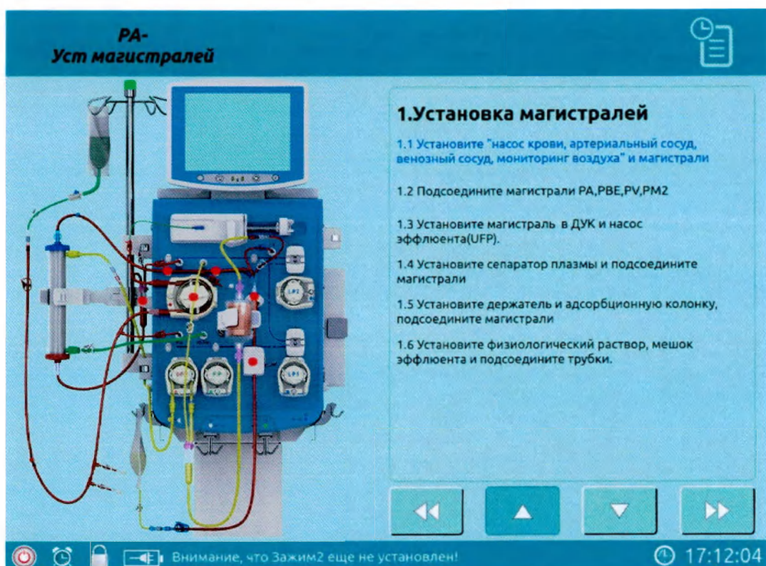
Рис. 6-50 Установка магистралей для АП (РА)
