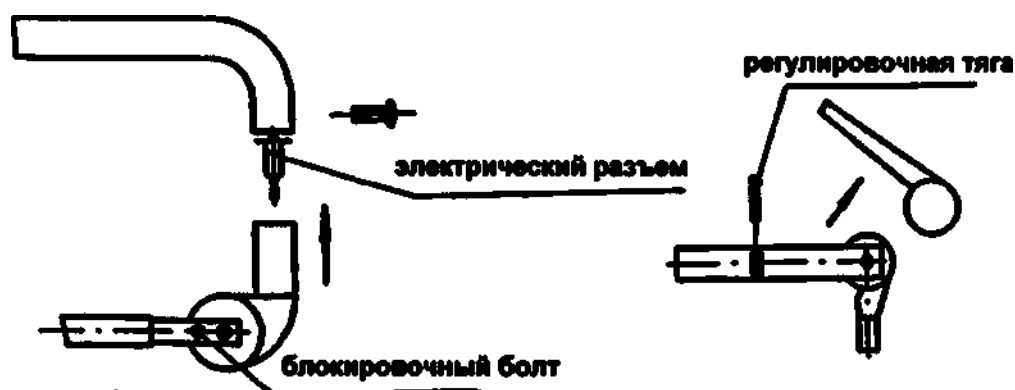
Рис. 8 Установка балансировочной части 1 Рис.9 Установка балансировочной части 2
