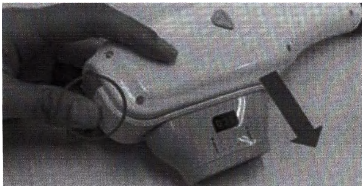
Рисунок 41 – Отделение картриджа HI-REX для обработки лица D 3.0 от манипулы HI-REX для обработки лица и тела FACE
