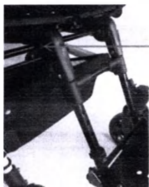
Фото 31. Регулировка положения угла наклона подножки
