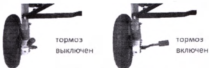
Фото 34. Механизм рычага тормоза задних колес (GT Stick 3)
