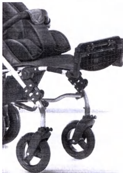
Фото 52. Механизм регулировки подножки – положение вверх
