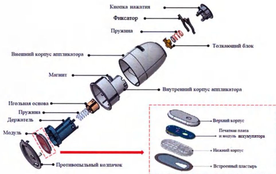
Рисунок 5 - Аппликатор с предустановленным сенсором в разборе
