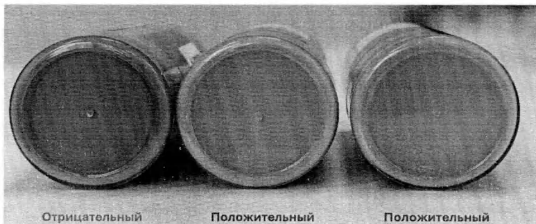
Рисунок 6. Визуальное сравнение положительных и отрицательных сигналов колориметрического датчика
