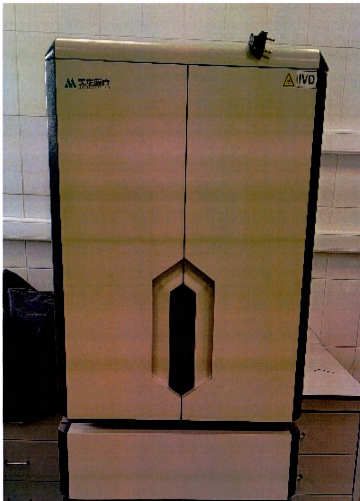
Рисунок. Анализатор автоматический бактериологический BC256 в составе: Верхний блок на 128 флаконов с установочной платформой
