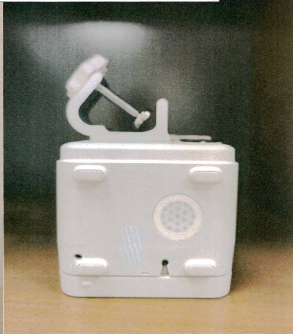
Насос инфузионный BeneFusion iVP - блок основной с установленным зажимом-фиксатором для крепления на стойке (стандартный). Вид сверху и снизу
