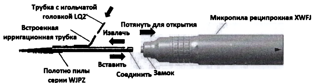
Рисунок 14 – Установка и снятие полотна пилы серии WJPZ
