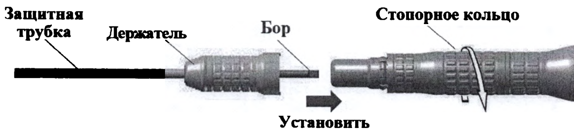
Рисунок 12 – Установка и снятие бора серии JZTM
