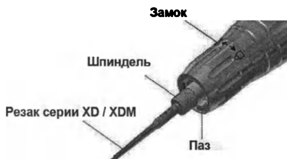
Рисунок 7 – Установка и снятие резака и насадки с фиксированным ограничителем глубины резки (XJH12F / XJH18F / XJH26F)
