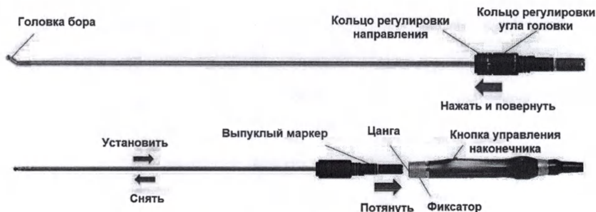
Рисунок 14 – Установка и снятие бора серии LB
