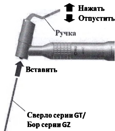
Рисунок 8 – Установка и снятие винтового сверла серии GT или бора серии GZ
