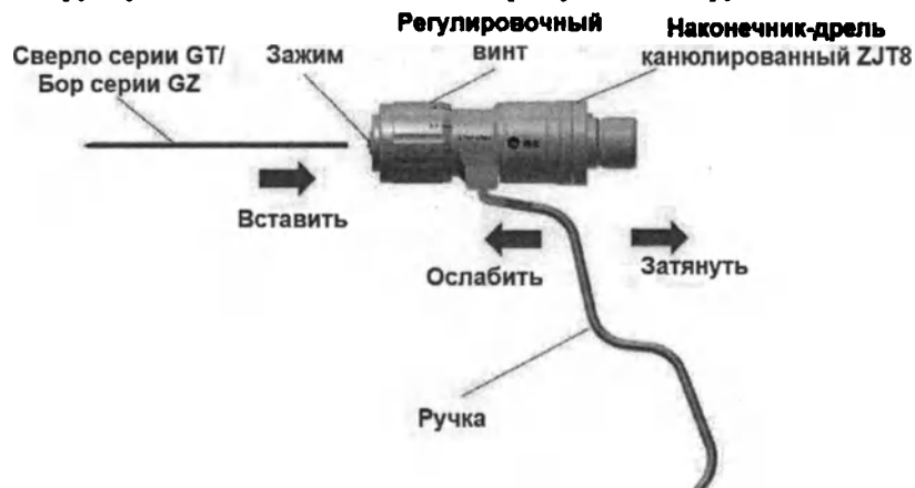
Рисунок 10 – Установка и снятие винтового сверла серии GT или бора серии GZ
