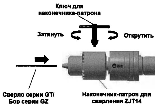
Рисунок 9 – Установка и снятие винтового сверла серии GT или бора серии GZ
