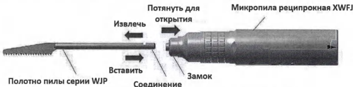
Рисунок 13 – Установка и снятие полотна пилы серии WJP
