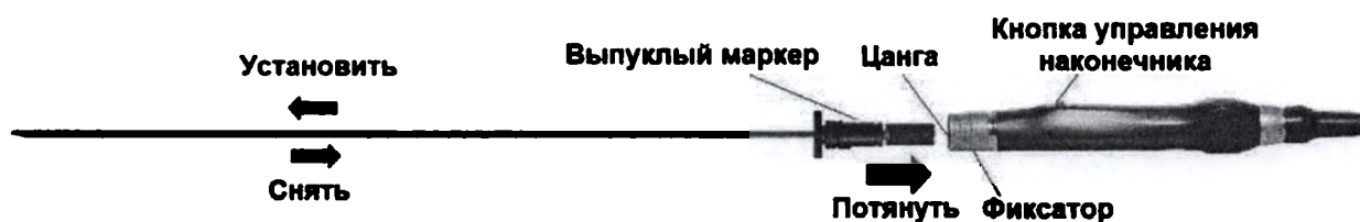
Рисунок 13 – Установка и снятие бора серии JZT
