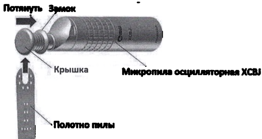
Рисунок 8 – Установка и снятие полотна пилы серии ВЈР
