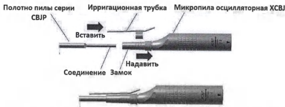
Рисунок 12 – Установка и снятие полотна пилы серии СВЖР
