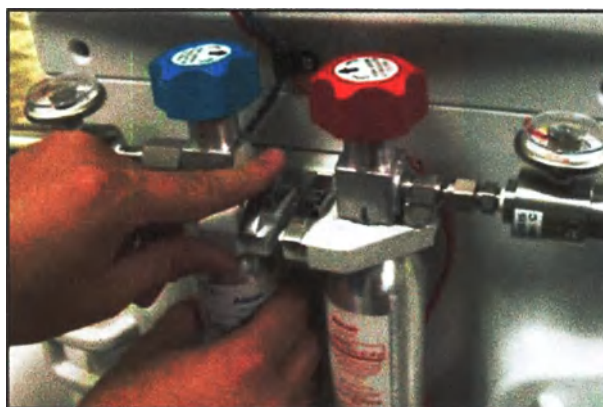
Рисунок 3-9 Установка собранного баллона/регулятора на задней панели тележки-подставки
