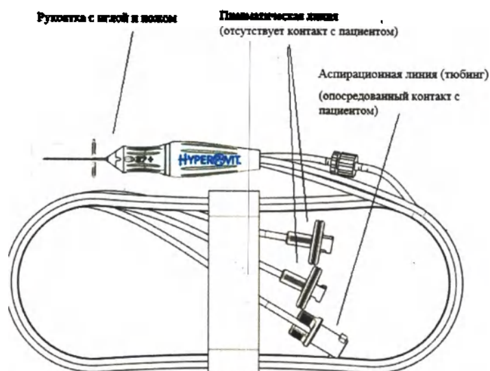
Рисунок 2-107 Схематическое изображение зонда для витрэктомии HYPERVIT™
