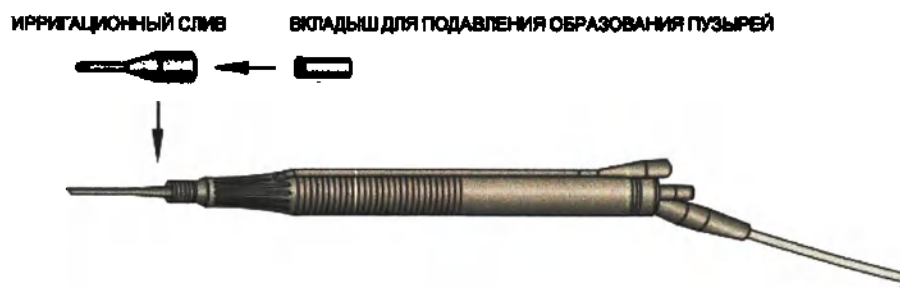
Рисунок 2-112 Рукоятка ультразвуковая Infiniti® (8065750121) с ирригационным сливом и с вкладышем для подавления образования пузырей
